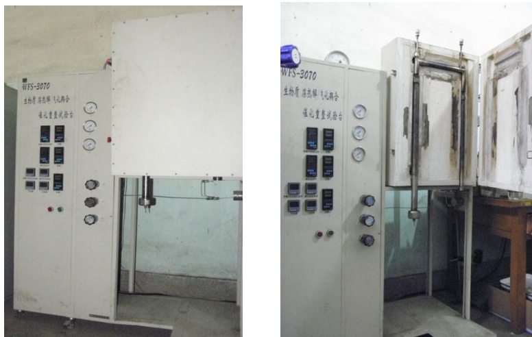
生物质、煤热解/气化耦合催化重整试验台
